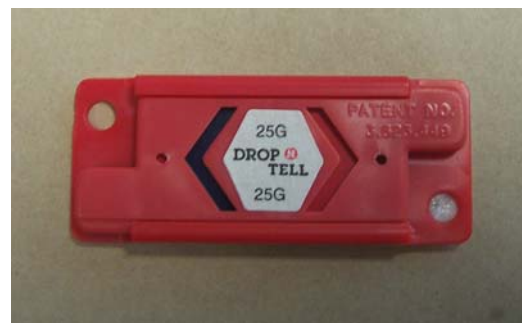
ausgelöster Stoßindikator dropping-indicator with drop response
