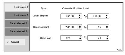
Fig. 4: Control parameter settings
