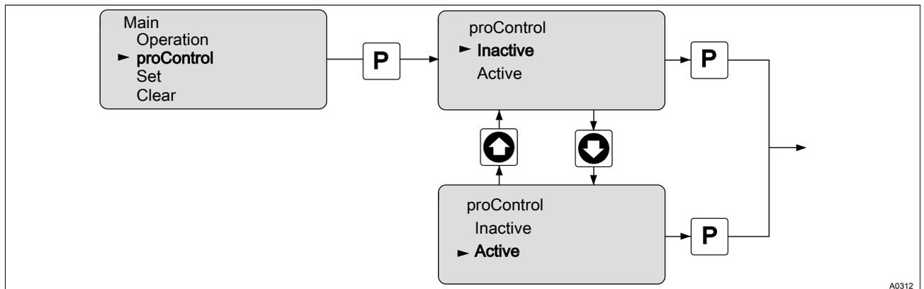
Fig. 14: Activate/deactivate control module delta<sup>®</sup>
