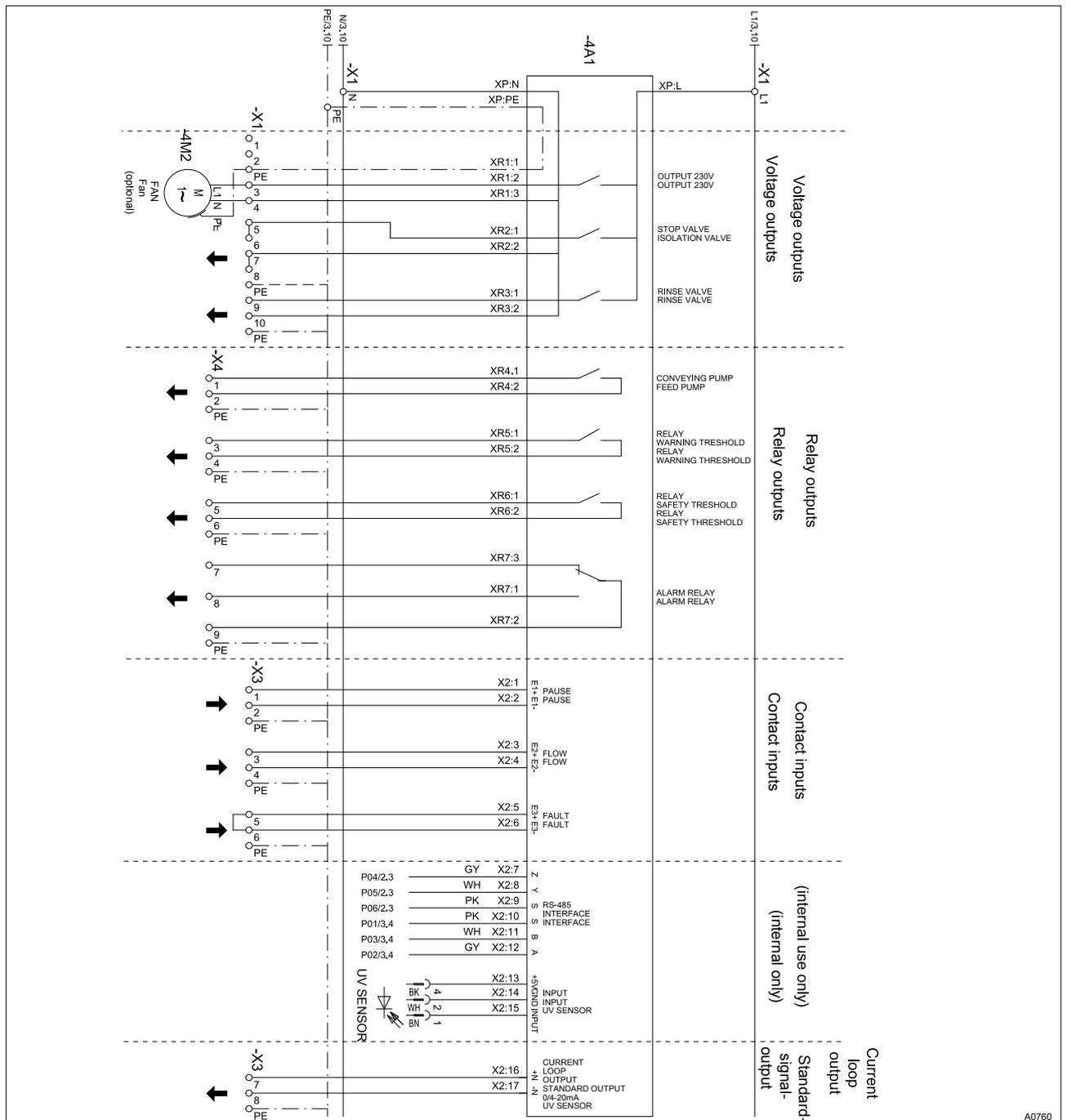
Fig. 57: Terminal Wiring Diagram
