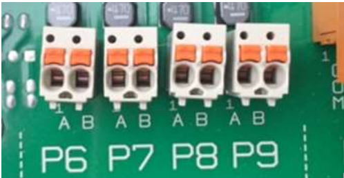
Figure 29 Digital DC (Pulse) outputs 6-9
