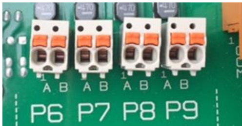
Figure 29 Digital DC (Pulse) outputs 6-9
