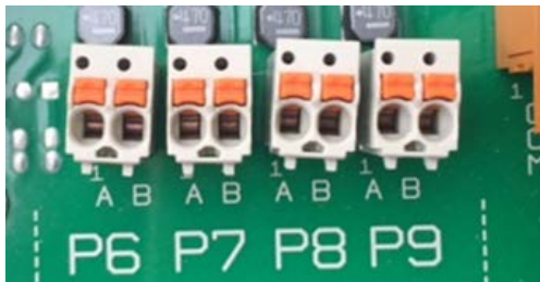
Figure 29 Digital DC (Pulse) outputs 6-9
