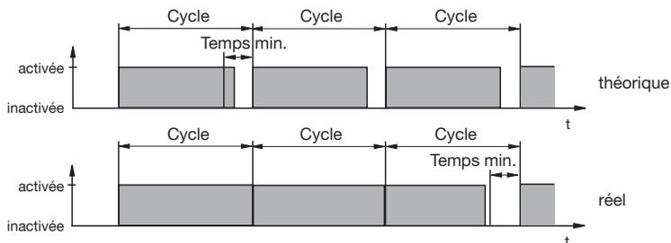
Le DULCOMETER® D1C ne se met pas hors circuit pendant autant de cycles nécessaires jusqu’à ce que les différences entre le cycle et le temps de commutation théorique dépassent par le haut le “temps min.”.
