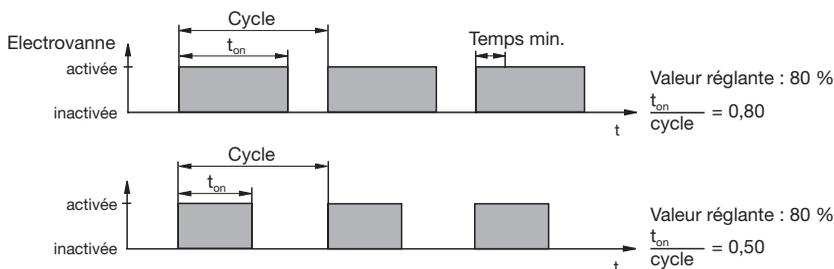
Les temps de commutation du DULCOMETER® D1C (électrovanne) dépendent de la valeur réglante et du “temps min.” (durée de mise en circuit minimale admissible de l’appareil raccordé).
