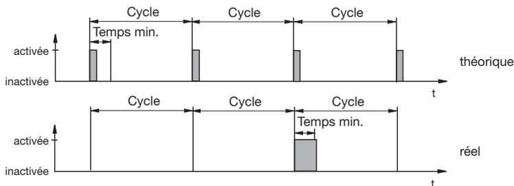
Le DULCOMETER® D1C ne se met pas en route pendant autant de cycles nécessaires jusqu’à ce que la totalité des temps de commutation théoriques dépasse par le haut le “temps min.”. Après quoi, il se trouve activé pour la durée totale de ces temps.
